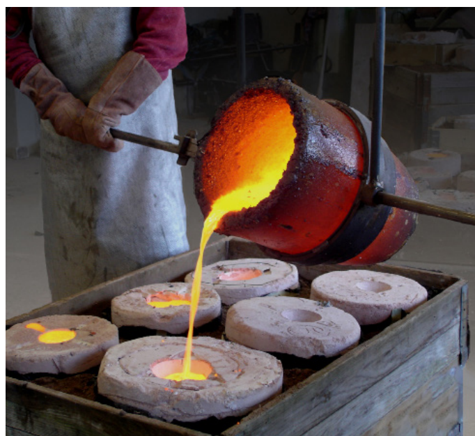
Jytte i gang på værkstedet på værkstedet med form bearbejdning, støbning med den 1.100 grader varme bronze og den afsluttende patineret.
